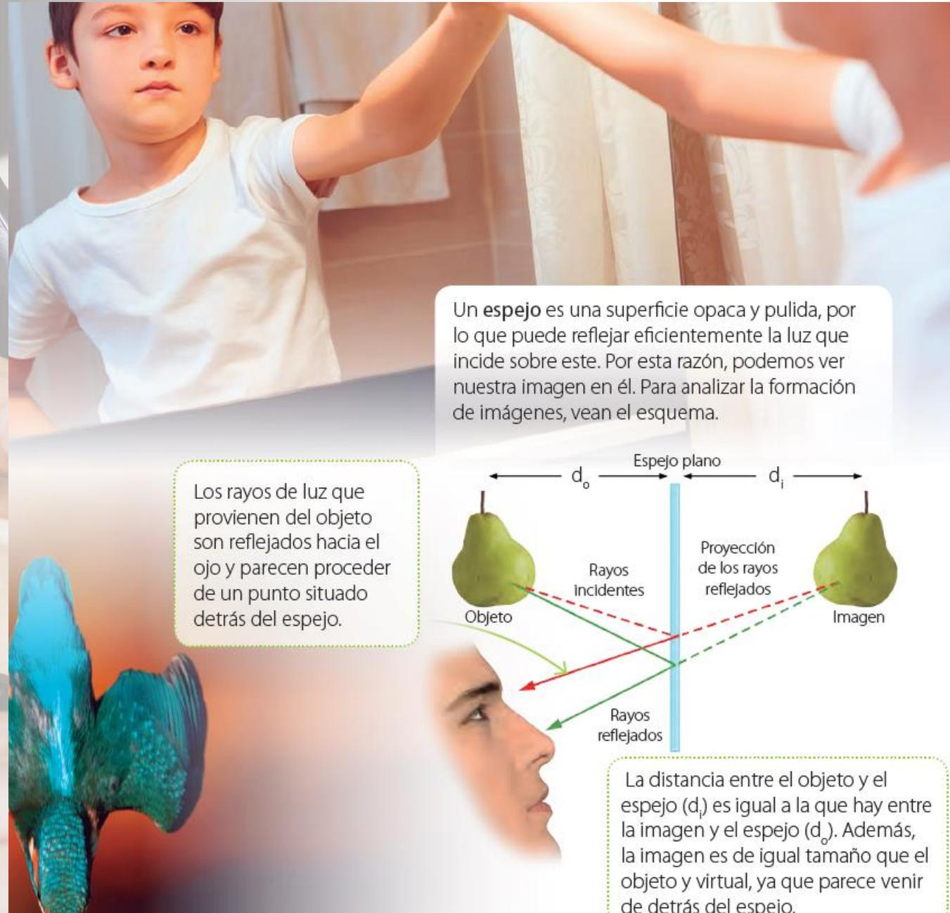
Un **espejo** es una superficie opaca y pulida, por lo que puede reflejar eficientemente la luz que incide sobre este. Por esta razón, podemos ver nuestra imagen en él. Para analizar la formación de imágenes, vean el esquema.
