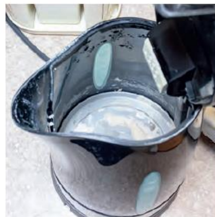
Depósito sólido de carbonato de calcio ( \text{CaCO}_3 ) adherido a la superficie interna de un hervidor eléctrico, conocida como «sarro».
